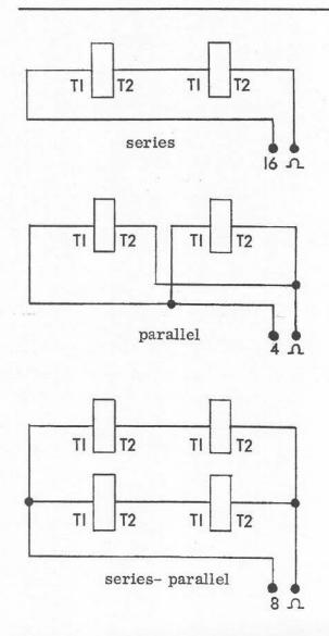
Fig. 3 — Wiring Diagrams
